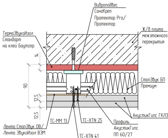
В состав системы не включены фиксирующие крепежные элементы для виброподвесов. Фиксирующие крепежные элементы подбираются самостоятельно в зависимости от состава основания потолка, функциональности помещения и требований к безопасности.
